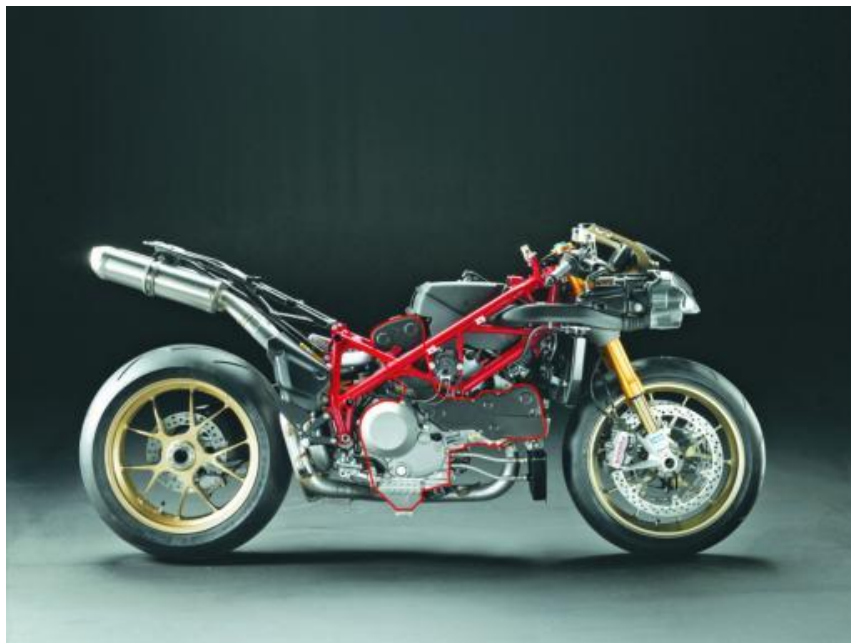
Фото 8. Только один цилиндр стоит вертикально.
