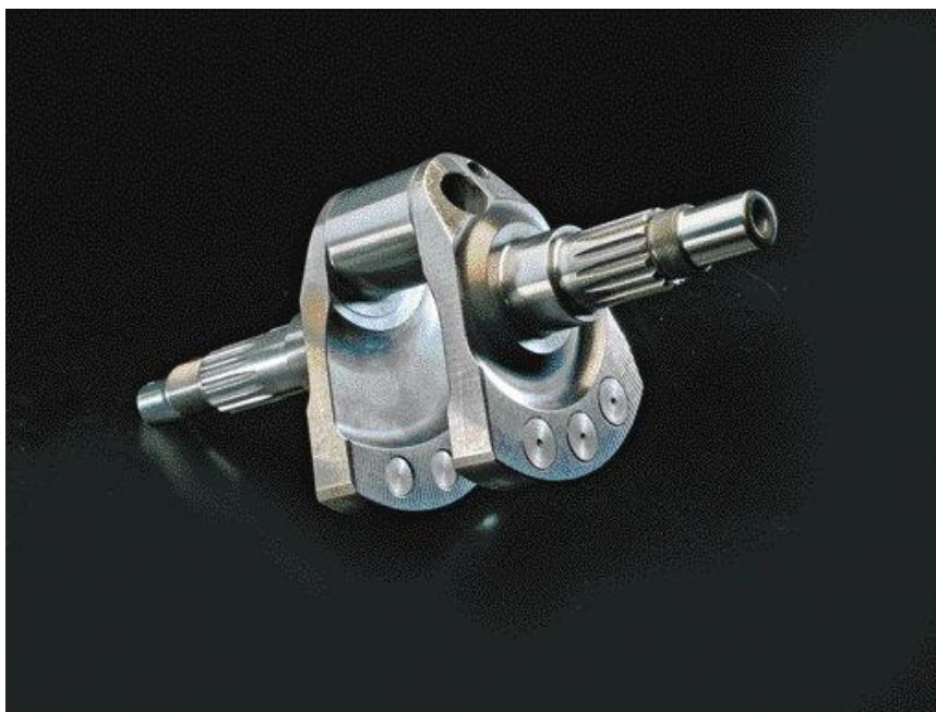
Фото 6. «Маленький» коленвал большого мотора (Ducati1098).
