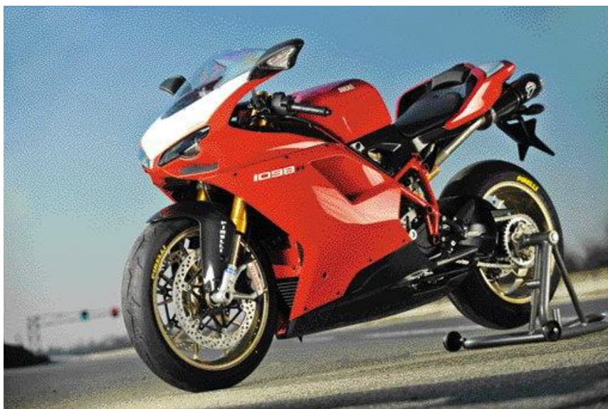
Фото 4. Ровный боковой обтекатель улучшает аэродинамику.
