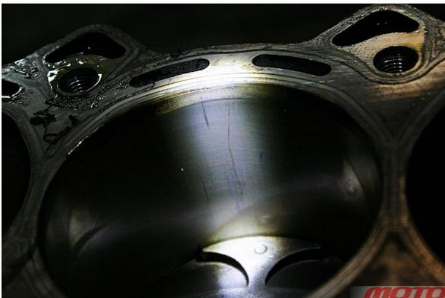
*Пыль, попадающая в цилиндр, работает как абразив, в разы сокращая ресурс мотора, а в некоторых случаях еще и приводя к задирам на «зеркале».*
