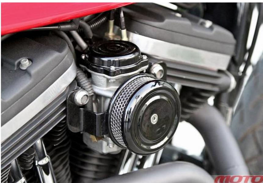
*Менять родной короб с фильтром на нештатные «грибки» в домашних условиях не стоит. Изменившееся разрежение и резонансные волны на впуске потребуют не только настройки карбюратора, но и зажигания, а также, возможно, придется изменять длину выпускного коллектора.*
