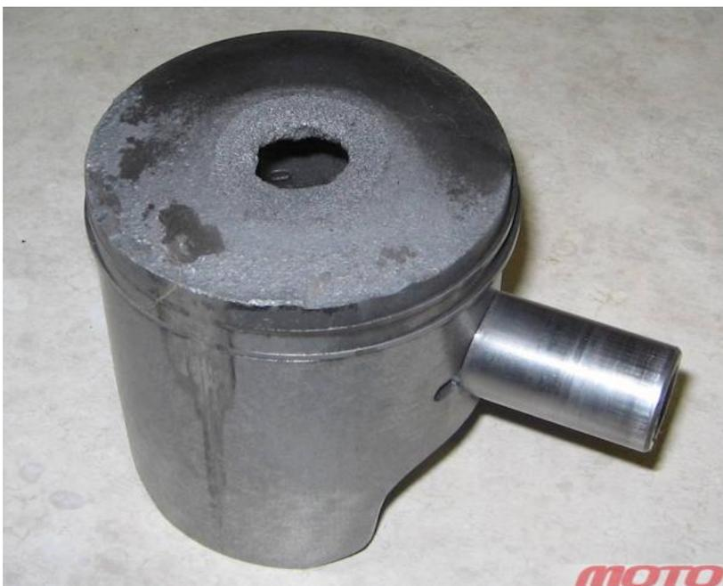
*Прогоревший поршень – результат работы двигателя на переобогащенной смеси. «Прожечь» его на 4-тактном моторе не так уж и просто, хотя случается, а вот 2-тактный, из-за больших нагрузок и температур, – напротив, запросто. Поэтому там «правильность» смеси особенно важна.*
