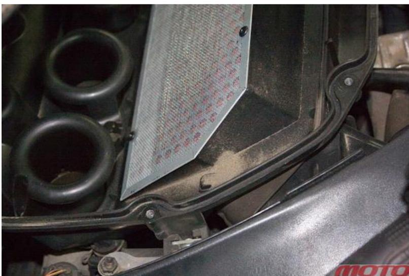
*Песок в коробе воздушного фильтра – вина «нулевика». Своевременное обслуживание фильтра проблему минимизирует, но не решает.*
