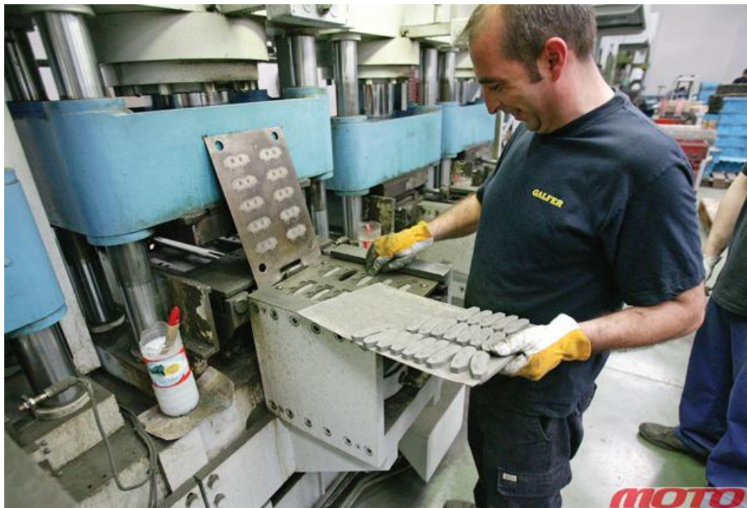
...сначала укладывают в формы вместе с металлическими пластинами...
