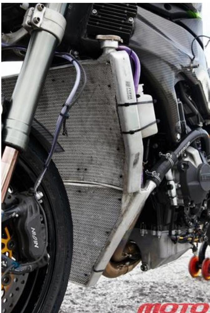
*Ради облегчения вентиляторы системы охлаждения допускается демонтировать. Чтобы двигатель не закипал, установлен увеличенный и по площади, и по толщине радиатор Febur. С ним удается поддерживать оптимальную температуру 70–75 °С.*
