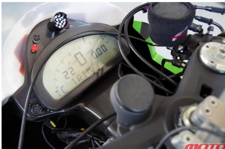
*Приоритеты на приборной панели MoTeC CDL3 можно расставить самостоятельно. Мне наиболее наглядным показался такой вариант: номер передачи и тахометр – в центре, температура охлаждающей жидкости – левее от них, а индикатор уровня трекшин-контроля – в правом нижнем углу.*
