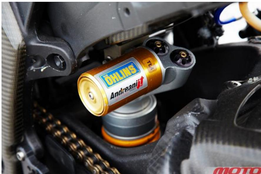
*Карtridge вилки Öhlins NIX30 и моноамортизатор Öhlins TTX36 MKII прошли через тонкую настройку признанных авторитетов из Andrea's Group. Под определенный трек может подбираться не только гидравлика, но и пружины разной жесткости.*
