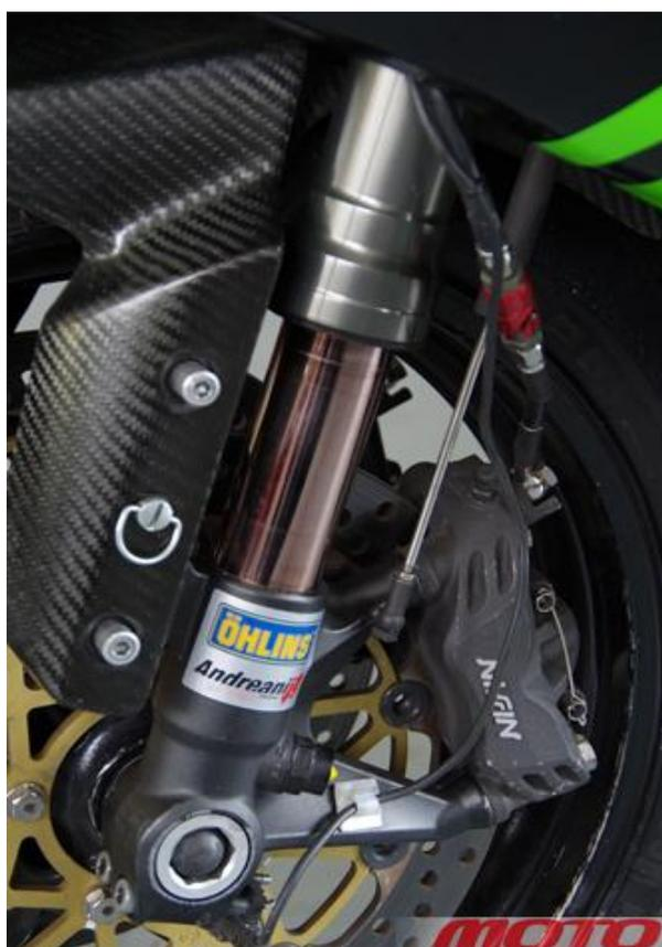
*В ту пору, когда мотоцикл участвовал в чемпионате мира, крепление переднего крыла выглядело несколько иначе – на двух втулках с быстросъемными шпильками. Эта хитрость помогала максимально ускорить процесс замены переднего колеса: вытаскиваешь пару шпилек, выкручиваешь ось колеса, разводíš в сторону суппорты – и можно вынимать. На всю операцию обычно уходило не более минуты.*
