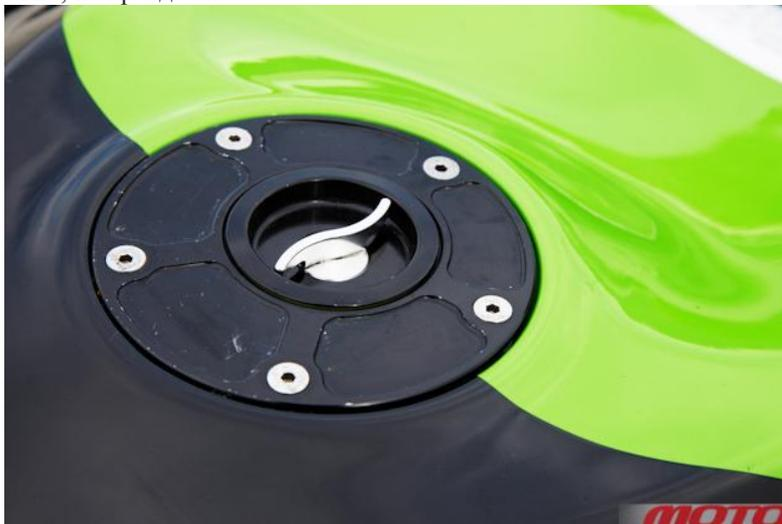
*Стандартная крышка бака заменена на быстросъемную, а внутренний объем заполнен специальной бензостойкой губкой (она страхует от вытекания топлива при повреждении).*
