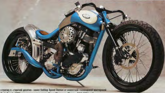
Шестую строчку в «горячей десятке» занял боббер Speed Demon от известной голландской мастерской Special Parts Supply (SPS) под предводительством Эрика Мартенса. Мотор – S&S (1524 см 3 ). Коробка – 6-ступенчатая Baker. Рама – модифицированный мастерами SPS «риджид»-Rolling Thunder. Обратите внимание на скульптурную красоту нижней части рамы, маслялиновую горловину под рулевой колонкой (маслобакom служит рама) и по-велосипедному закрепленный руль.
